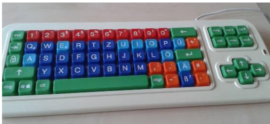
Abbildung 11: robuste Tastatur mit farbkodierten Tasten
