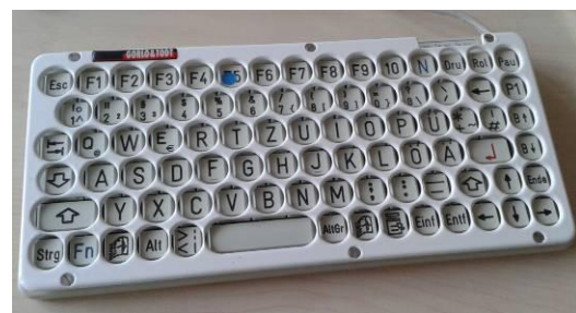
Abbildung 10: Verkleinerte Tastatur mit Fingerführung
