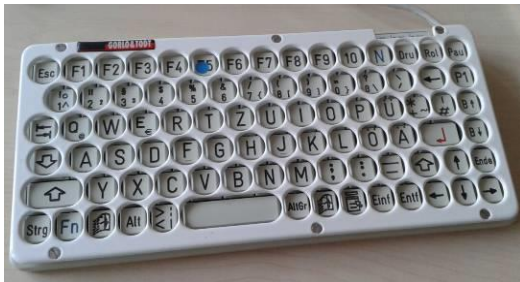
Abbildung 14: verkleinerte Tastatur mit Fingerführungsgitter
