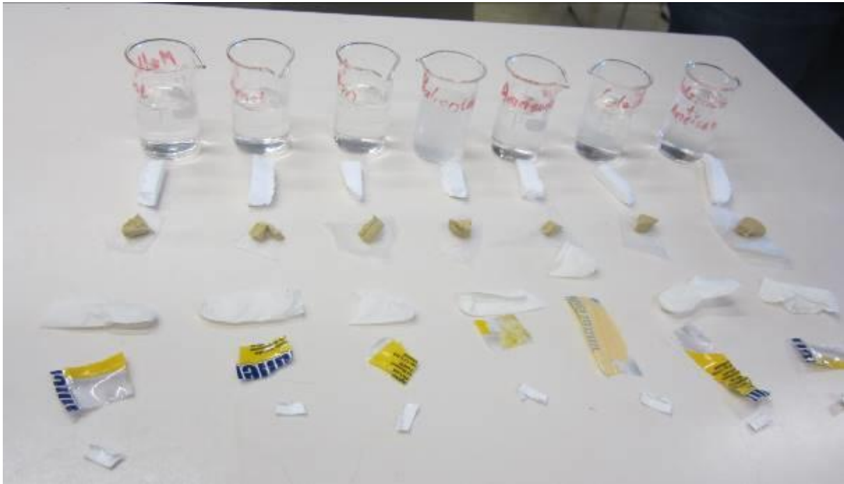
Abb. 6: Versuchsaufbau „Lösemittelbeständigkeit von Kunststoffen“ hier mit den Lösemitteln Methanol, Butanol, Salzsäure 1 molar, Ameisensäure, Natronlauge 1 molar, Aceton, Salzsäure und Ameisensäure
