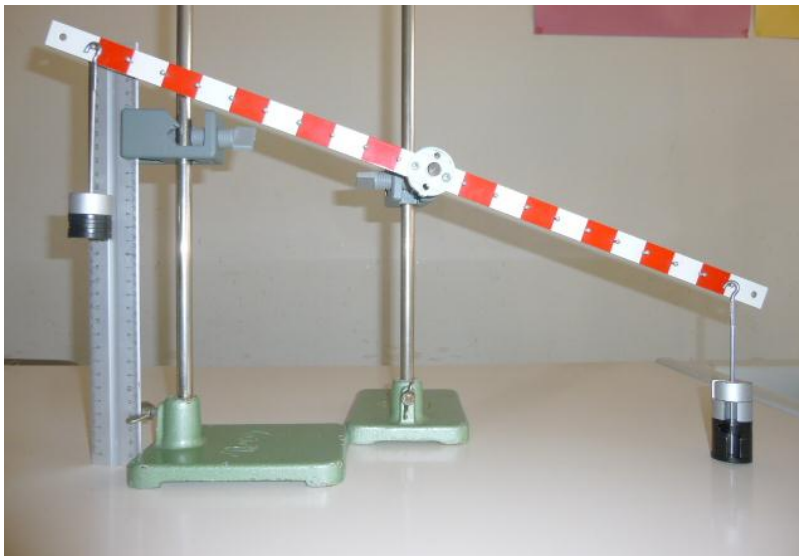
Abbildung 3: Doppelte Masse entspricht doppelter Gewichtskraft
