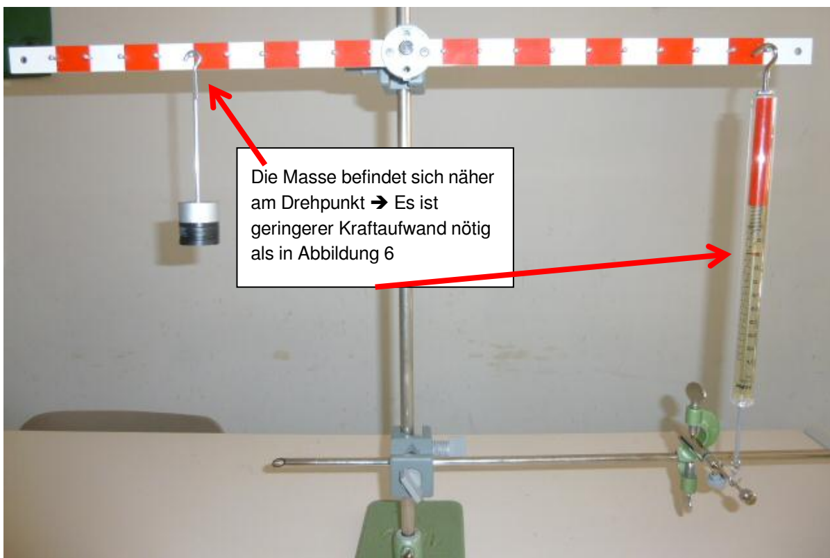
Abbildung 6 und 7: Messung der Gewichtskraft einer festgelegten Masse bei veränderter Länge des Hebelarms mit Hilfe einer Federwaage.
