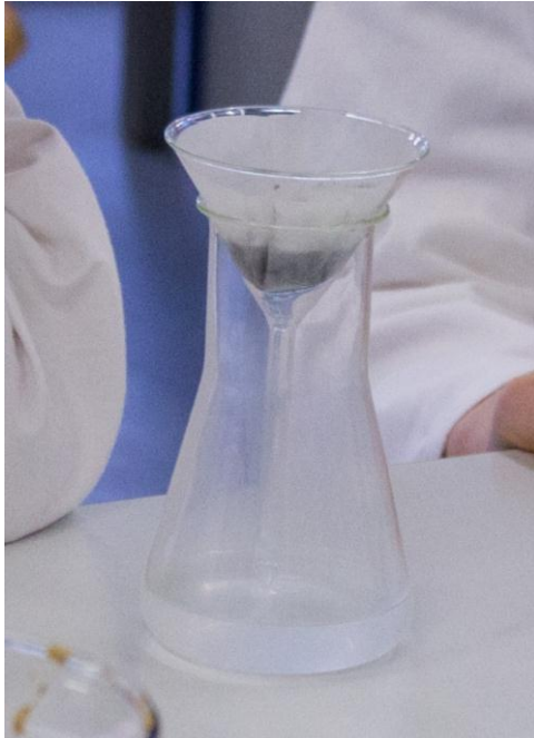
Abbildung 3: Ergebnis des Schülerversuchs → Gefiltertes Wasser ohne Salatöl.
