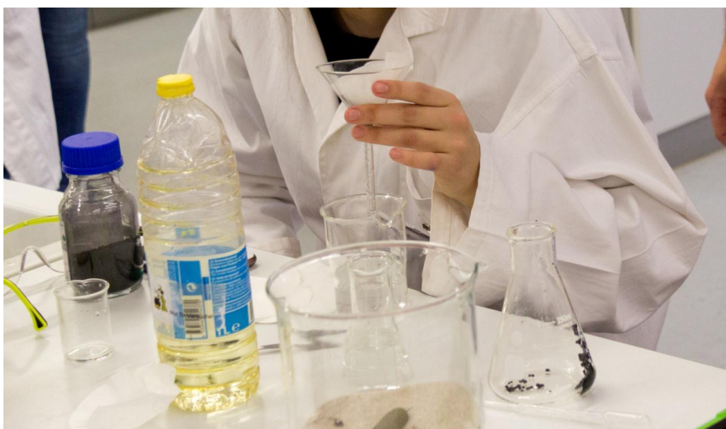
Abbildung 2: Versuchsdurchführung durch die Schülergruppe → Trennen der flüssigen Bestandteile Wasser und Salatöl mit Hilfe von Aktivkohle.
