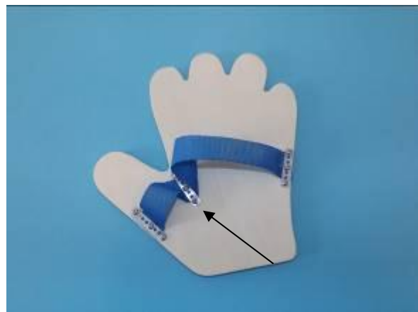
Abb. 4: Notwendige Bohrungen zur Fixierung des Gurtes mit Hilfe von Lochband/Beilagscheiben.
