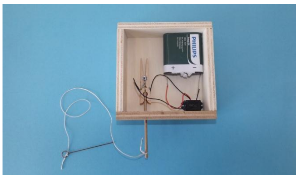
Abb. 5 Stromkreis unterbrochen – Holzstab befindet sich in der richtigen Bohrung
