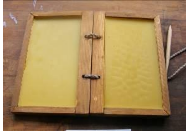
Abb. 2: Rahmenkonstruktion - auf Gehrung
