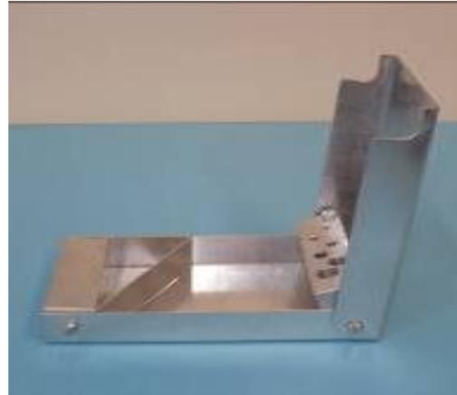
Abb. 6: Alternative: Bohrerfassung
