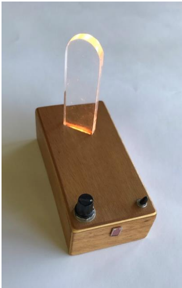
Abb. 5: Lichtobjekt mit LDR und Acryl-Leuchtkörper
