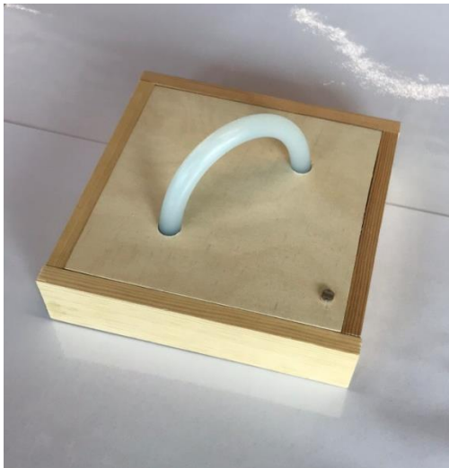
Abb. 1: Schülerarbeit mit LDR und Klebepatrone als Leuchtkörper
